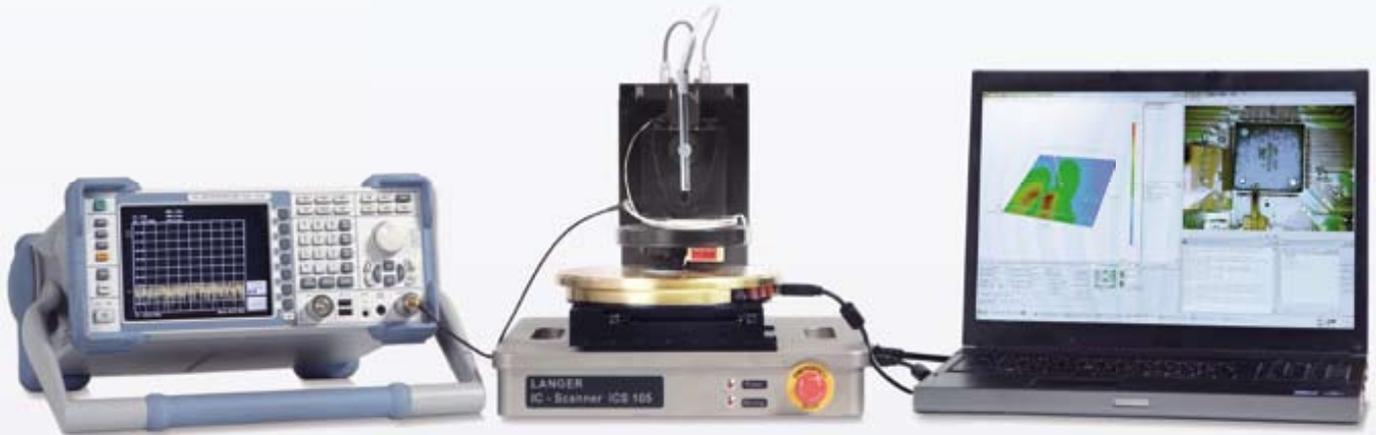
ICS 105 IC-Scanner beim Oberflächenscan eines ICs
